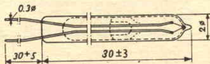
- Dimensioni e forma del varistore E205CE/P usato come sonda termometrica.
